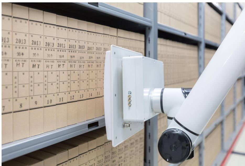
图 8 档案机器人进行盘点工作
